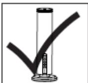
1- يرجى إبقاء الجهاز رأسياً بعد التركيب. قد تسبب إمالة الجهاز أو وضعه مسطحاً في انسكاب الزيت، وقد تتلوث لوحة الدوائر، مما قد يؤثر على كفاءته.
